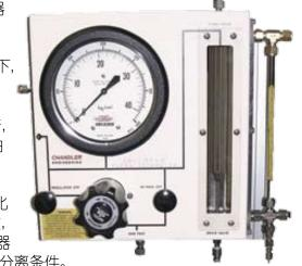
2353 闪蒸分离器的一级分离器室,入口配有高精度计量针阀,出口通向二级接收器管配有排放阀。一级分离器室容积为30 ml,配有压力表以及背压调节器(可通过截止阀隔离),用于调节控制分离器压力。整个压力系统通过一个隔离阀与大气隔离。一级分离器室和二级接收器管都有刻度,以便手动测量液体体积。
