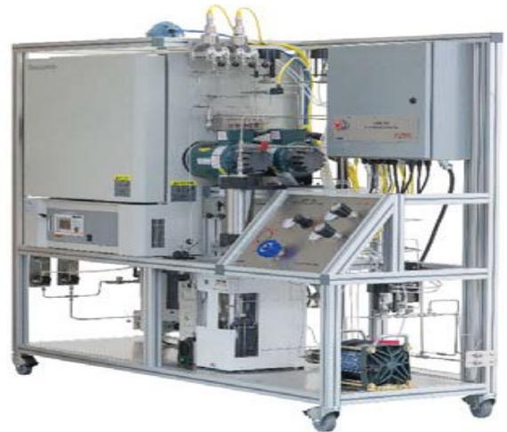
8500 型高温高压泡沫流变仪是一个全自动流变仪, 操作者通过系统配套的计算机控制软件就可控制泡沫质量、剪切速率、剪切应力、测试时间长度、实验温度, 8500 泡沫流变仪利用标定过的体积来计算和控制泡沫质量的百分比。
