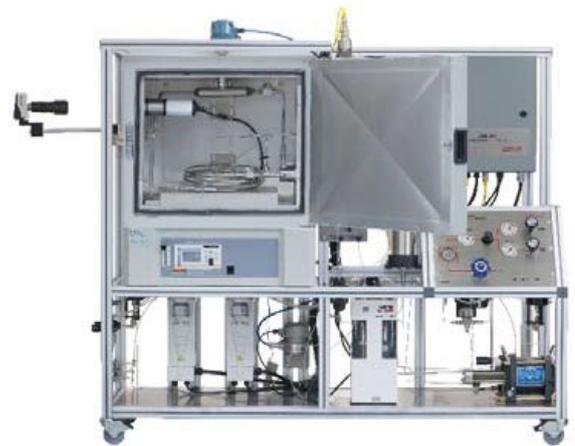
试验时将基液流体放入系统配备的中间容器 (系统配备 2 个中间容器, 中间容器可以放置不同的样品液体), 然后用计算机软件控制精密计量泵将中间容器的液体注入测量流变的毛细管线, 维持系统压力到试验压力。然后操作者在计算机软件上选择 CO<sub>2</sub> 或者 N<sub>2</sub>、启动泡沫发生器以及系统配备的容积泵, 泡沫发生器叶轮高速转动产生泡沫, 产生的泡沫将泵入烘箱内的毛细盘管内循环, 预设的多余体积或者质量的流体通过系统配备的真空泵排出毛细盘管, 逐步增加 CO<sub>2</sub> 或者 N<sub>2</sub> 压力到试验压力, 根据计算机软件设定的剪切速率一直循环盘管内的泡沫液, 直到泡沫液的密度和泡沫分布已稳定, 可通过泡沫观察釜视窗直观观察泡沫, 也可以通过 CCD 计算机图像软件捕捉泡沫液视频或者图像, 观察泡沫分布、泡沫半衰期、泡沫稳定性等特性。
